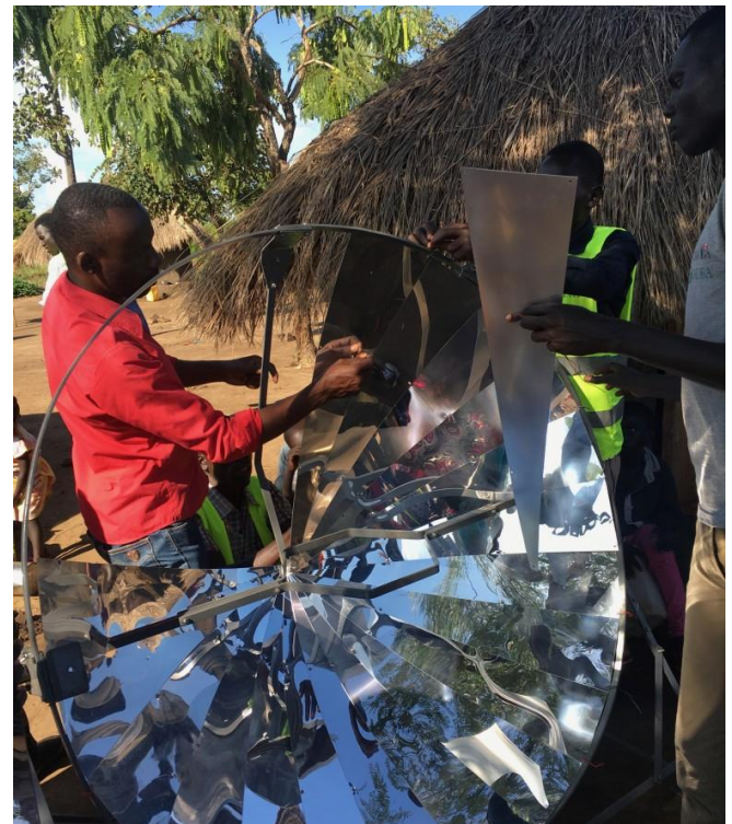
Montage des Solarkochers SK14
